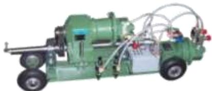
Para trabajo en tuberías entre 18" a 24" de diámetro.
