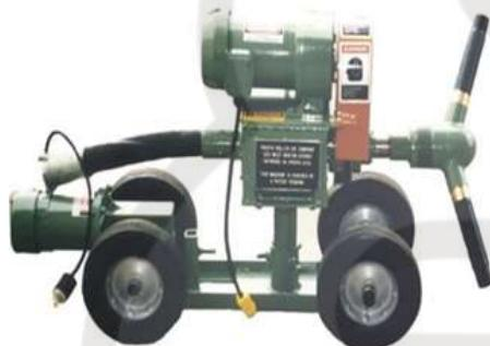
Limpia tuberías de 24 a 72 pulgadas (600 mm a 1800 mm) de diámetro, incluye el carro auto propulsado, cabezal de granallado rotativo independiente, difusor rotativo, ajuste de diámetro, acoples para la manguera del sistema de granallado con aire presurizado existente y controles externos de operación.
