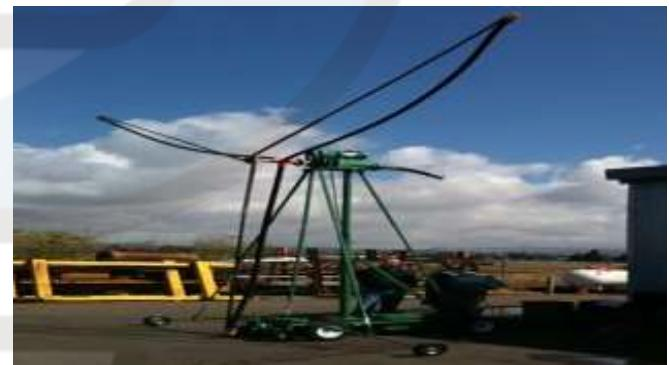
Diseñado especialmente para tuberías con diámetros entre 6 a 32 ft (1.800 mm a 9.750 mm). Con un accesorio especial adicional, este equipo logra trabajar en tuberías de diámetros mayores. El modelo 101B incluye el carro auto propulsado, cabezal de granallado rotativo independiente, torre de descarga, controles externos de operación y acoples de conexión a sistemas de granallado con tolva y aire presurizado.
