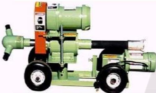
Limpia tuberías de 18" a 24" (450 mm a 600 mm) de diámetro, incluye el carro auto propulsado, cabezal de granallado rotativo independiente, difusor rotativo, ajuste de diámetro, acoples para la manguera del sistema de granallado con aire presurizado existente y controles externos de operación.
