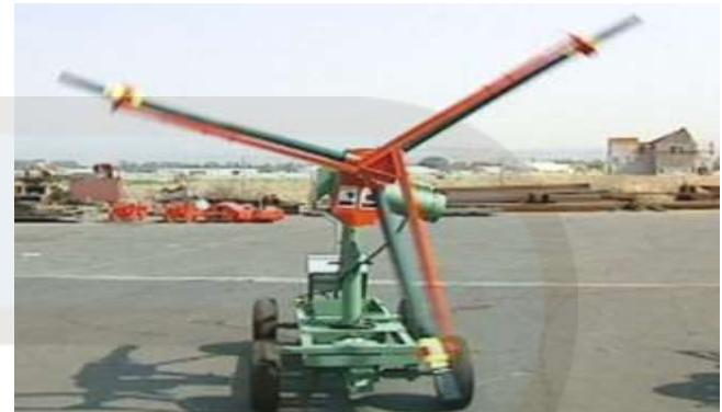
Trabaja en tuberías con diámetros de 4 a 12 ft (1.200 mm a 3.600 mm). Incluye el carro auto propulsado, cabezal de granallado rotativo independiente, torre de descarga, controles externos de operación y acoples de conexión a sistemas de granallado con tolva y aire.
