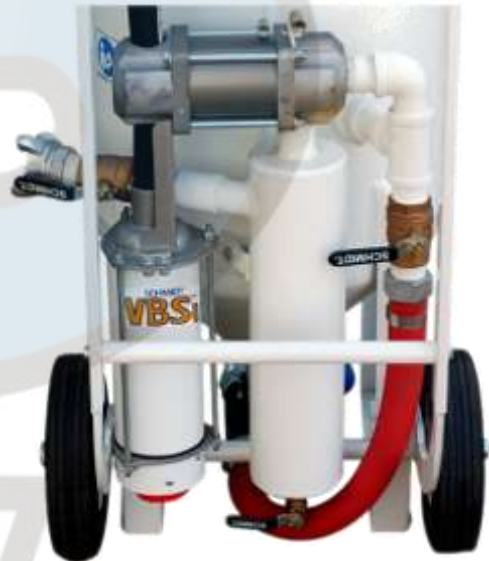
VBS II de Axxiom Manufacturing, Inc. en la parte Posterior de una tolva Schmidt para granallado
