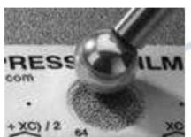
producir una réplica con un aspecto de grano uniforme. Normalmente se requieren de 30 a 60 segundos para comprimir completamente todas las partes de la película en la mayoría de las superficies. En general, el exceso de compresión es más seguro que demasiado poca. Una vez finalizado el perfilado retire la cinta de réplica de la superficie.
